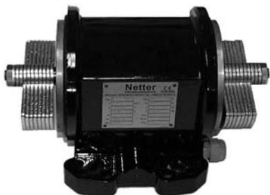
2. Die Unwuchtverstellung (Grobeinstellung) erfolgt durch Drehen von einer Lamellenscheibe je Seite um 180° auf der Welle.
