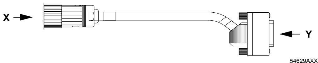
Typen Resolverkabel RH.M für MOVIAXIS® MX
